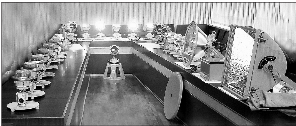
Елементи світлосигнального обладнання, які були встановлені на аеродромі Старокостянтинів для проведення льотних відомчих випробувань.
